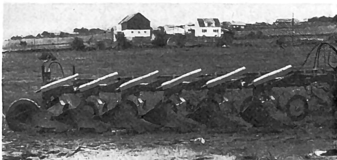
Aspect de la charrue polysoc semi-portée Kyllingstad à six corps, du modèle 2001 Gigant, pour les labours en planches.
