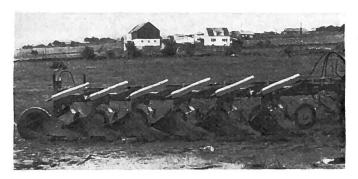
Aspect de la charrue polysoc semi-portée Kyllingstad à six corps, du modèle 2001 Gigant, pour les labours en planches.
