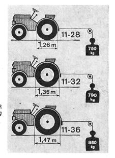
Profil pneu tracteur AR Charge d'essieu 1250 kg Pression de gonflage 0,8 bar Force de traction avec 50% de glissement Sol: limon sableux ferme et sec
