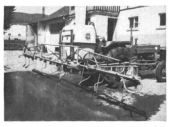
Fig. 27: Pulvérisateur pour traitements phytosanitaires, au pied des plantes, dans les cultures de maïs. Les buses (à jet plat) sont fixées sur des supports rigides disposés à proximité du sol. Ces supports peuvent être déplacés tant dans le sens vertical que dans le sens horizontal et ainsi adaptés aux divers interlignes.
