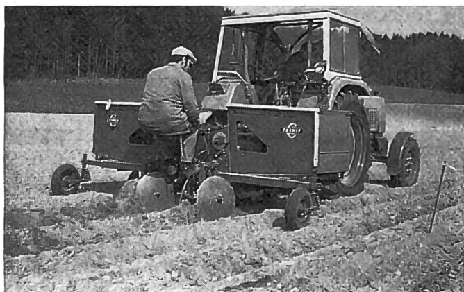
Fig. 24: Planteuse de pommes de terre automatique pour deux lignes à éléments pourvus d'un ruban ou d'une chaîne à quatre rangs de godets. Le réglage des organes d'amenage (fonds roulants peu inclinés) exige une personne de service.
