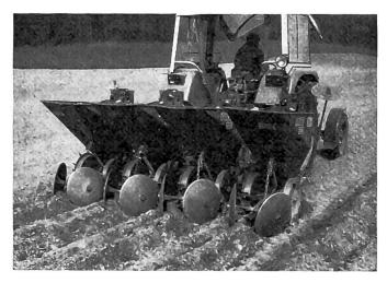
Fig. 23: Planteuse de pommes de terre automatique pour quatre lignes à éléments munis d'un ruban (ou d'une chaîne) à deux rangs de godets.
