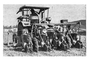
Fig. 31: Emblavage d'un champ avec du maïs par une semeuse monograine et épandage simultané de microgranulés insecticides. Les granulés sont déposés tout près des semences de maïs (essai effectué avec deux types différents d'épandeurs de microgranulés).
