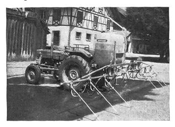
Fig. 28: Pulvérisateur pour traitements phytosanitaires, au pied des plantes, dans les cultures de maïs. Il a été équipé d'une rampe spéciale. Les buses grand-angulaires extérieures (160°) sont fixées sur des supports traînants, ce qui permet d'effectuer les pulvérisations toujours à égale distance du sol, même sur les terrains inclinés ou accidentés. Les extrémités de la rampe sont relevées lors des virages.
