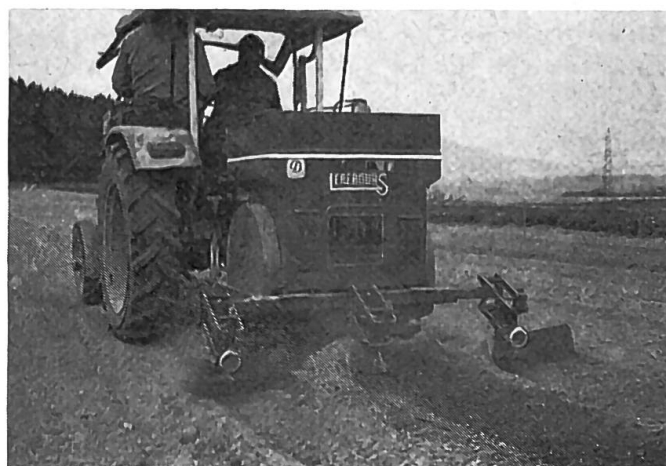
Fig. 25: Planteuse de pommes de terre à roue extractrice à doigts. L'indicateur électrique des manques donne au conducteur du tracteur la possibilité de contrôler commodément le fonctionnement de la machine.
