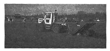
Fig. 26: Les machines avec grande trémie d'alimentation permettent de planter des pommes de terre sur une superficie de 7 à 9 hectares en une seule journée. La plantation de semenceaux prégermés est un problème qui n'a toutefois pas encore été résolu de manière satisfaisante jusqu'à maintenant.
