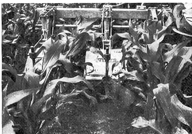
Fig. 30: Une lutte efficace contre les mauvaises herbes peut être également menée avec une fraiseuse à lames pour cultures en lignes (actionnée par la prise de force) équipée de corps butteurs.
