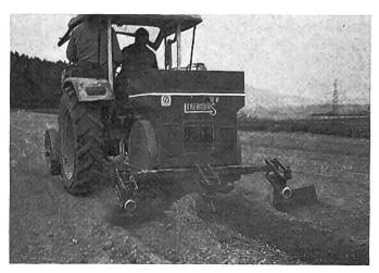
Fig. 25: Planteuse de pommes de terre à roue extractrice à doigts. L'indicateur électrique des manques donne au conducteur du tracteur la possibilité de contrôler commodément le fonctionnément de la machine.
