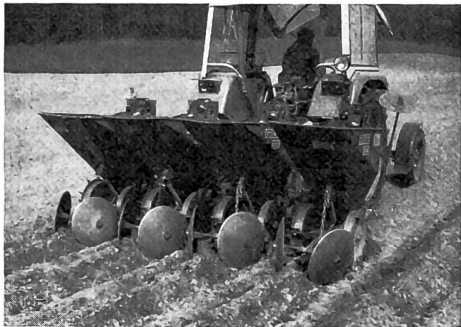
Fig. 23: Planteuse de pommes de terre automatique pour quatre lignes à éléments munis d'un ruban (ou d'une chaîne) à deux rangs de godets.
