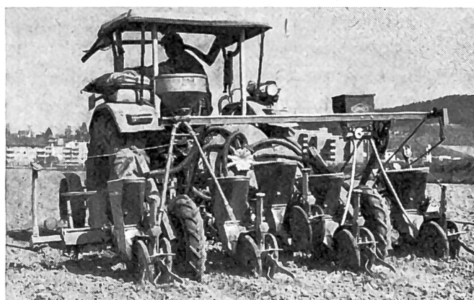
Fig. 31: Emblavage d'un champ avec du maïs par une semeuse monograin et épandage simultané de microgranulés insecticides. Les granulés sont déposés tout près des semences de maïs (essai effectué avec deux types différents d'épandeurs de microgranulés).
