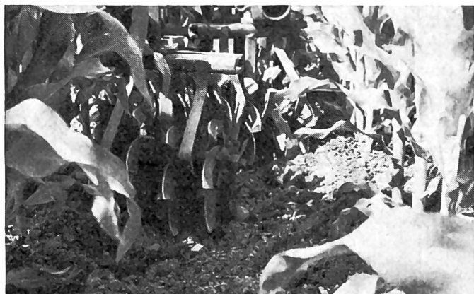
Fig. 29: La sarcleuse avec éléments comportant des lames courbes disposées en étoile a fait ses preuves dans les cultures de maïs pour lutter contre certaines espèces de plantes adventices (millets). Le buttage réalisé par les lames inclinées en question assure le recouvrement, sur les lignes, de ces végétaux indésirables.
