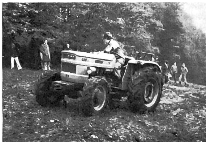
Fig. 3: Rouler avec un tracteur à quatre roues motrices sur un pareil terrain ne pose pas de problèmes. L'essieu avant a été supplémentaiement alourdi avec des poids.
