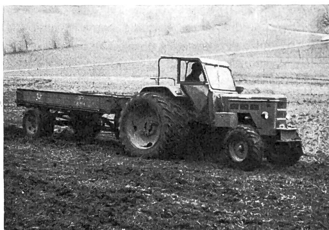
Fig. 2: Ce tracteur et cette remorque ont été équipés de roues jumelées. Les pneus avant du tracteur et ceux de la remorque, à sculptures, sont du type employé avec les camions automobiles. En outre, les roues avant du tracteur ont été pourvues de freins (actionnés par un levier spécial).
