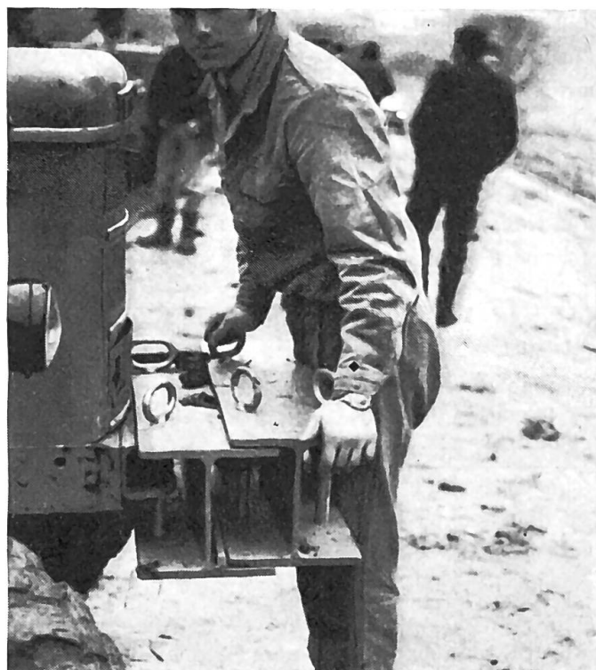
Fig. 1: Masses d'alourdissement à fixer sur le devant du tracteur qui ont été confectionnées par un agriculteur au moyen d'une poutre de fer façonnée en H.
