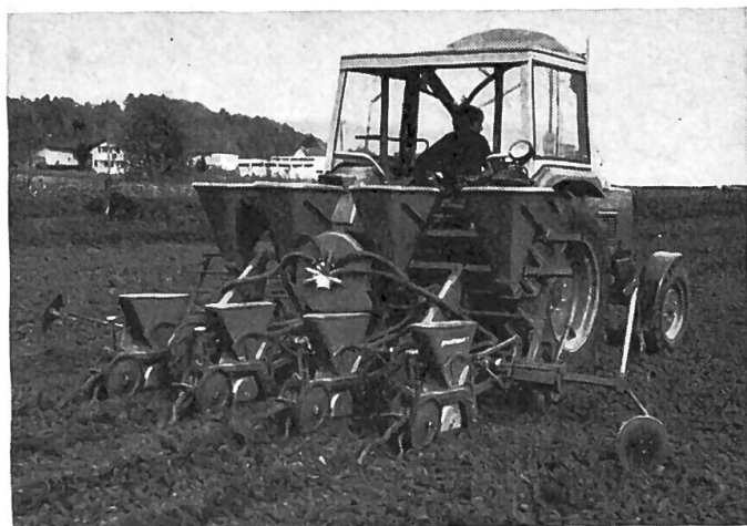
Fig. 21: Semeuse monograine pneumatique avec distributeurs d'engrais. Cet ensemble de matériels effectue simultanément l'emblavage du champ avec du maïs et la localisation d'un fertilisant à 5 cm à côté de la ligne de semis et à une profondeur de 10 à 12 cm.
