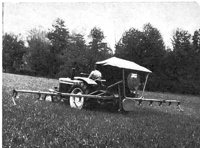
Fig. 19: Distributeur d'engrais à système pneumatico- mécanique, d'une largeur de travail de 9 m, exécu- tant une fumure de couverture. Cette machine peut épandre non seulement des fertilisants sous forme granulée ou cristallisée, mais aussi des microgranu- lés (si on l'équipe d'un cylindre distributeur-doseur de précision).
