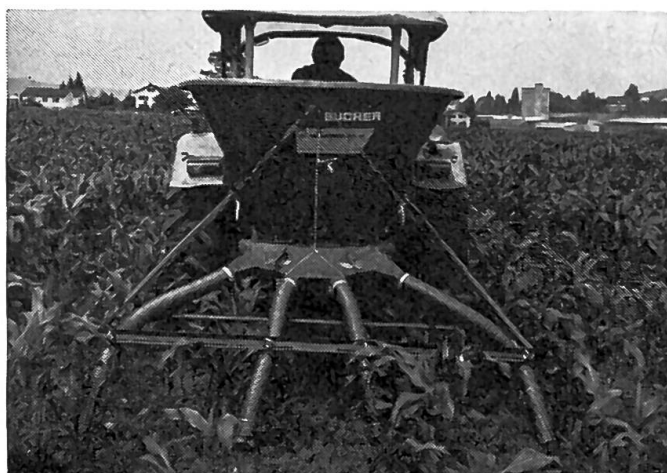
Fig. 18: Epandeur d'engrais centrifuge à deux disques distributeurs (trémie double biconique), muni d'un dispositif de localisation du fertilisant en ligne et en surface pour quatre rangs. L'engrais est épan- du ici au pied de plantes de maïs.
