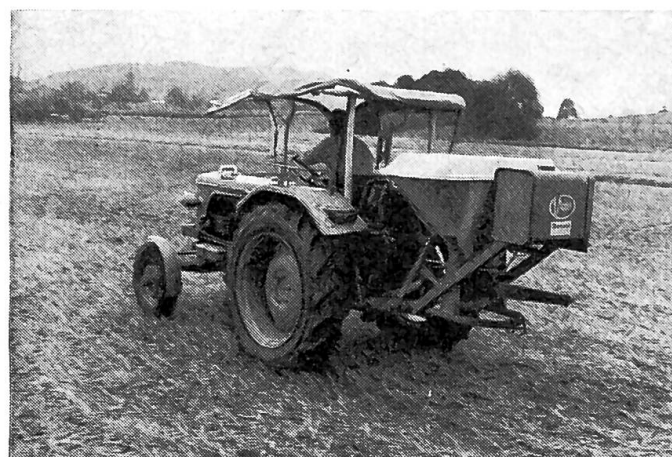
Fig. 17: Epandeur d'engrais centrifuge à tube oscillant qui a été équipé d'un humecteur et distribue des scories de déphosphoration. Selon ce système, l'engrais n'est humidifié que dans le tube projecteur.
