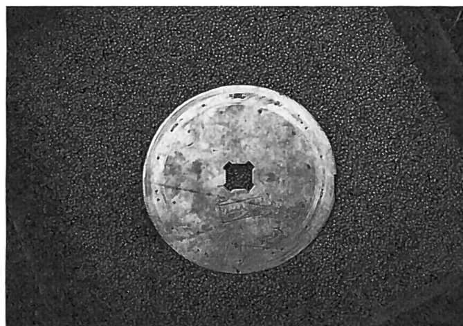
Fig. 22: Aspect du disque semeur d'un semoir monograine pneumatique permettant d'exécuter des ensemencements avec différents espacements des graines sur la ligne.
