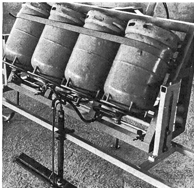
Fig. 2: Aspect de la batterie d'appareils (exécution prévue pour être adaptée au système d'attelage 3-points du tracteur) également destinée à la destruction des plantes adventices par déshydratation totale.
