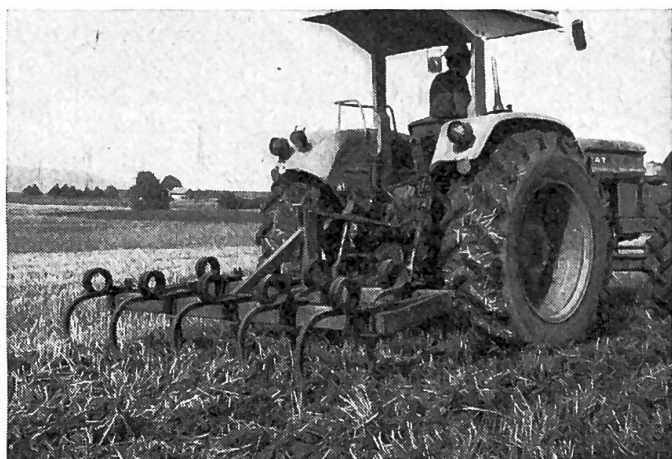
Fig. 3 et Fig. 4: Un chisel pourvu de dents rigides ou élastiques peut ameublir le sol jusqu'à une profondeur de 35 cm. Afin de briser les grosses mottes, il est toutefois souvent nécessaire d'utiliser complémentai- rement une herse roulante à lames (herse finnoise).
