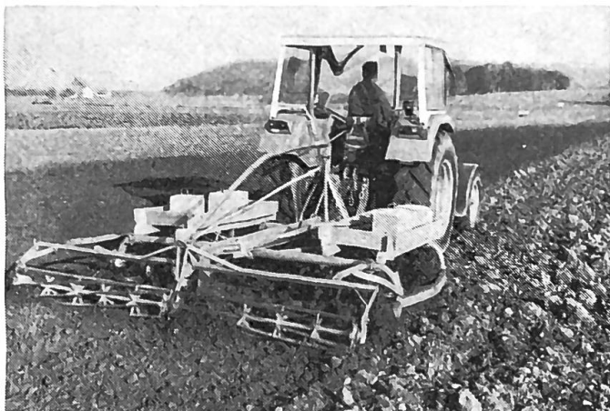
Fig. 9: La herse roulante à lames (herse finnoise), qui travaille la terre en profondeur en la mélangeant bien, convient plus spécialement pour la préparation des lits de germination dans les champs fraîchement labourés et aussi pour les déchaumages. L'efficacité de son action peut être encore accrue avec des masses d'alourdissement ainsi qu'une émotteuse dans le premier cas, et en employant au préalable un chisel dans le second cas.
