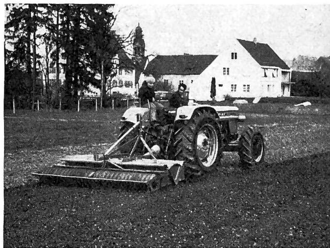
Fig. 10 et Fig. 11: Les herse à toupies et les fraiseuses à lames sont surtout indiquées là où les instruments traînés s'avèrent trop peu efficaces.
