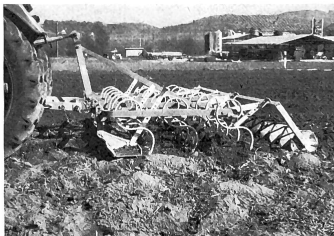
Fig. 8: Un cultivateur se montre indiqué pour la préparation de lits de germination d'une certaine profondeur, entre autres dans le cas des pommes de terre. La niveleuse fixée à l'avant aplanit le champ tout en écrasant les mottes.
