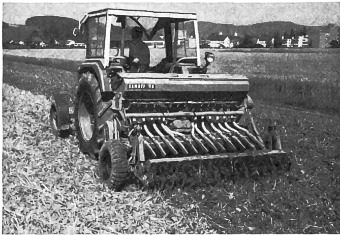
Fig. 12: Ameublissement et ensemencement simultanés du sol sans labour préalable. La machine utilisée (fraiseuse-semeuse) a donné particulièrement satisfaction pour les cultures dérobées (comme ici) ainsi que pour les cultures céréalières venant après des plantes sarclées ou du maïs.
