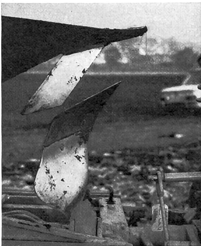
Fig. 5 et Fig. 6: Un bon émiettement de la paille de blé et des tiges de maïs sèches s'avère indispensable en vue des travaux d'ensemencement ou de plantation. D'autre part, une rasette spéciale et un couteur court facilitent énormément l'enfouissage de la paille (Fig. 6).
