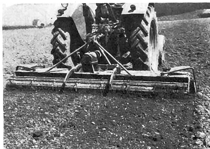
Fig. 10 et Fig. 11: Les herse à toupies et les fraiseuses à lames sont surtout indiquées là où les instruments traînés s'avèrent trop peu efficaces.
