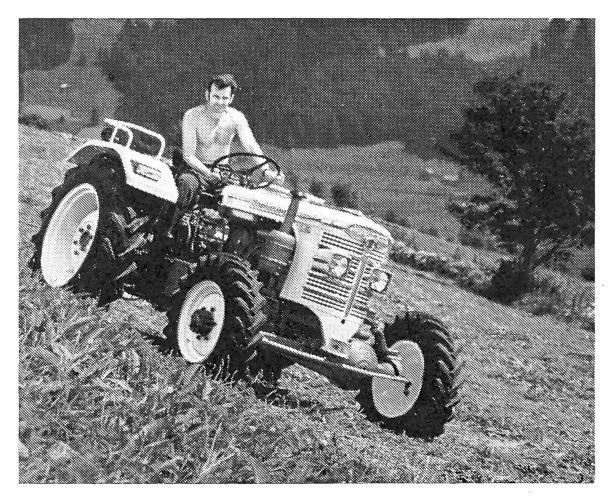
45 CV DIN / 50 CV SAE de puissance au frein 40 CV DIN / 44 CV SAE de puissance à la prise de force
