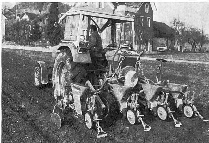
Fig. 7: L'épandeuse de microgranulés Nodet distribuant du Curaterre. A noter que les cinquième et sixième tuyaux souples d'épandage sont raccordés à la trémie. (Lors de la distribution de Dyfonate, il a fallu monter un récipient supplémentaire en bas pour les deux tuyaux souples non utilisés)
