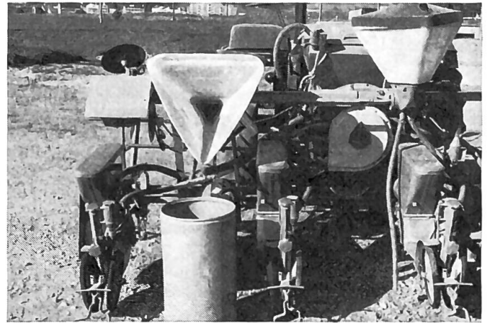
Fig. 8: Le vidage de la trémie par basculement ne présente aucune difficulté et se fait rapidement (microgranulateur Granyl)
