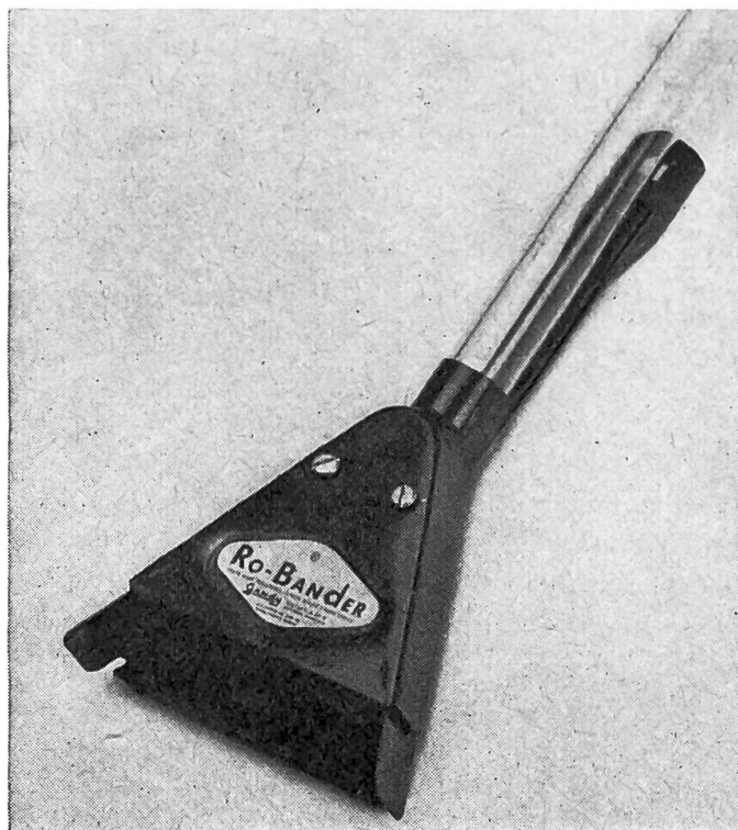
Fig. 3: Aspect du répartiteur de microgranulés en forme de queue de poisson.
