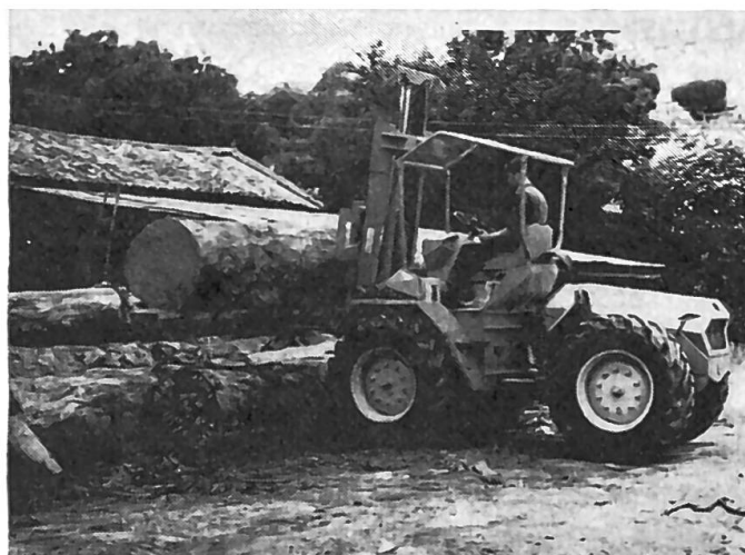
L'élévateur autotracté à fourche Faun-Termit K 431 — véhicule tous-terrains — mis en œuvre dans une scierie.
