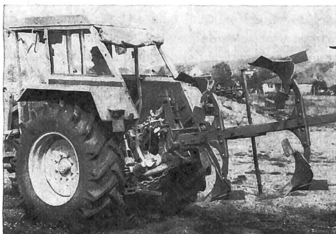
Fig. 2: Le nouveau dispositif d'attelage WKS permet à l'utilisateur d'accoupler facilement une charrue trisoc au tracteur sans qu'il lui faille descendre de son siège.
