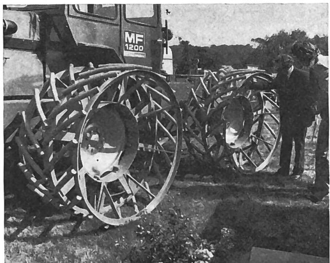
assure la répartition optimale du poids, confère à la machine de traction une adhérence maximale avec une compression minimale du sol.
