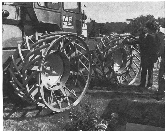
assure la répartition optimale du poids, confère à la machine de traction une adhérence maximale avec une compression minimale du sol.
