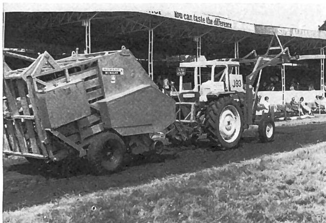
grandes dimensions. Cette griffe, montée à l'avant de la ramasseuse-presse, est actionnée par un vérin hydraulique à double effet. Le système «bigbaler» a été le premier de ce genre à confectionner de grandes balles parallélépipédiques de foin ou de paille. Ces balles peuvent être rapidement et facilement manutentionnées.
