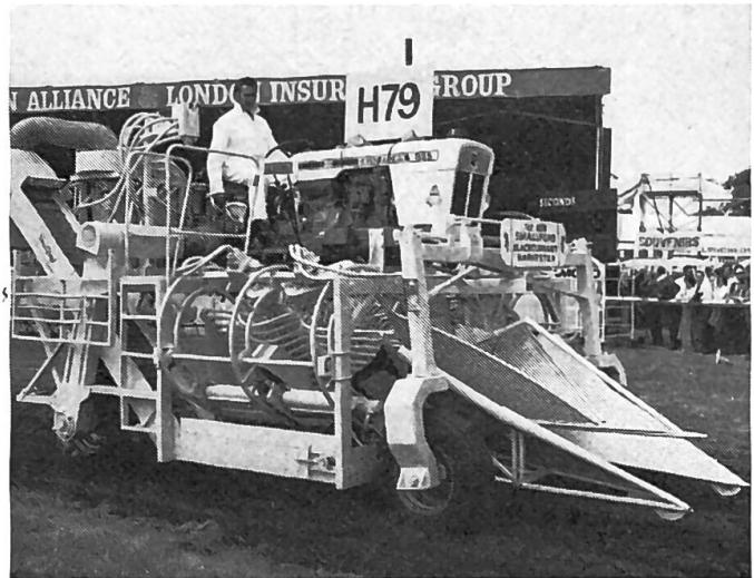
baies vers des dispositifs secoueurs. Il ressort des expériences faites jusqu'à maintenant que la cueillette mécanique du cassis doit se faire à une hauteur minimale d'environ 25 cm.
