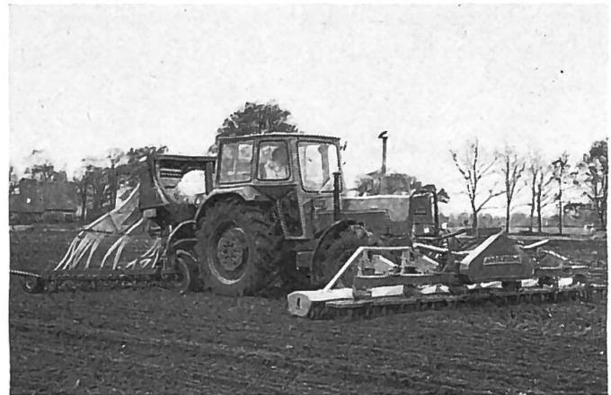
Le dispositif de relevage hydraulique et la prise de force montés à l'avant du tracteur Favorit 612 S permettent l'emploi économique de cette machine pour l'exécution de plusieurs travaux en un seul passage, comme on le voit ici (préparation du sol et semis, notamment). La machine accouplée frontalement est une herse alternative et celle attelée à l'arrière un semoir à grande capacité de travail. Les deux ont une largeur de 6 m.
