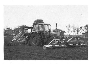
Le dispositif de relevage hydraulique et la prise de force montés à l'avant du tracteur Favorit 612 S permettent l'emploi économique de cette machine pour l'éxécution de plusieurs travaux en un seul passage, comme on le voit ici (préparation du sol et semis, notamment). La machine accouplée frontalement est une herse alternative et celle attelée à l'arrière un semoir à grande capacité de travail. Les deux ont une largeur de 6 m.
