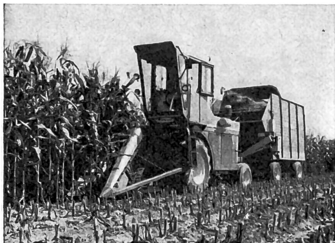
Fig. 1: Le véhicule dont il s'agit est notamment utilisable en tant que faucheuse-hacheuse-chargeuse à 3 rangs pour la récolte du maïs-fourrage.
