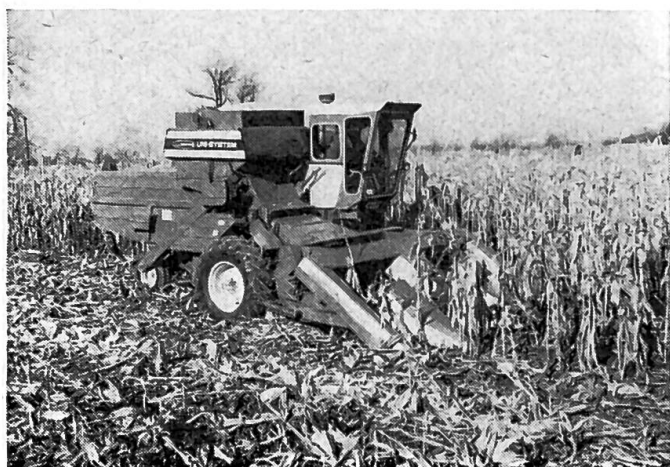
Fig. 2: Le même véhicule est employé ici comme ramasseur-égreneur d'épis de maïs.
