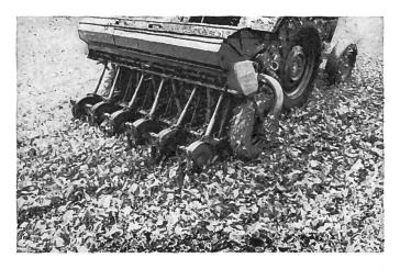
Du froment d'automne est semé ici dans une culture dérobée (colza) — emblavage direct sans aucune préparation du sol au préalable — à l'aide d'un semoir en lignes équipé de coutres circulaires. Les problèmes d'ordre technique posés par cette méthode d'emblavage ne sont cependant pas encore tous résolus.
