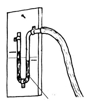
Le manomètre constitué d'un tube de verre recourbé en U peut être aussi confectionné à la ferme avec un tuyau souple transparent en matière plastique.
