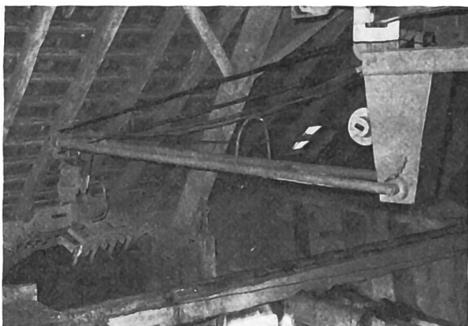
Fig. 9: Griffe de manutention fixée à une flèche pivotante qui a été installée dans une grange équipée d'un monte-charge à câbles.
