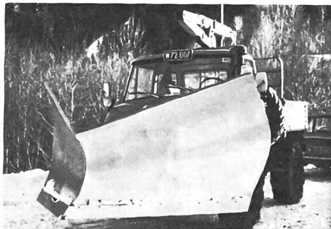
Fig. 3: Grand chasse-neige du type à étrave prévu pour exécuter d'importants travaux de déblaiement.
