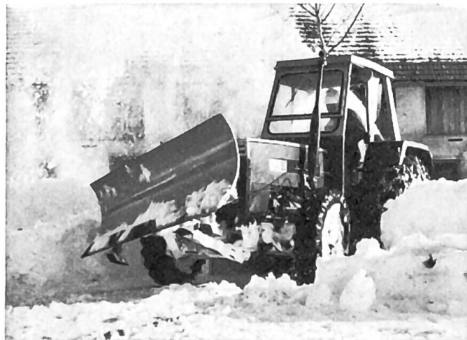
Fig. 1: Lame fixée à l'avant du tracteur pour le déblaiement de la neige.
