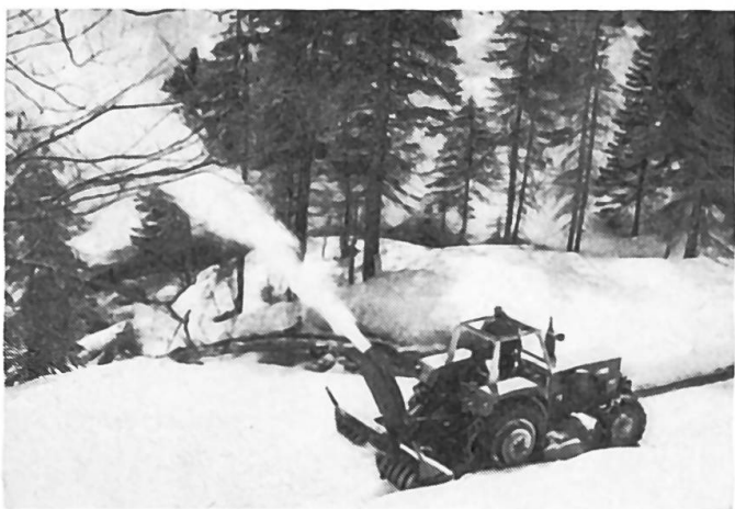
Fig. 4: Fraiseuse à neige à grande distance de projection travaillant sur une largeur de 2 m 20.
