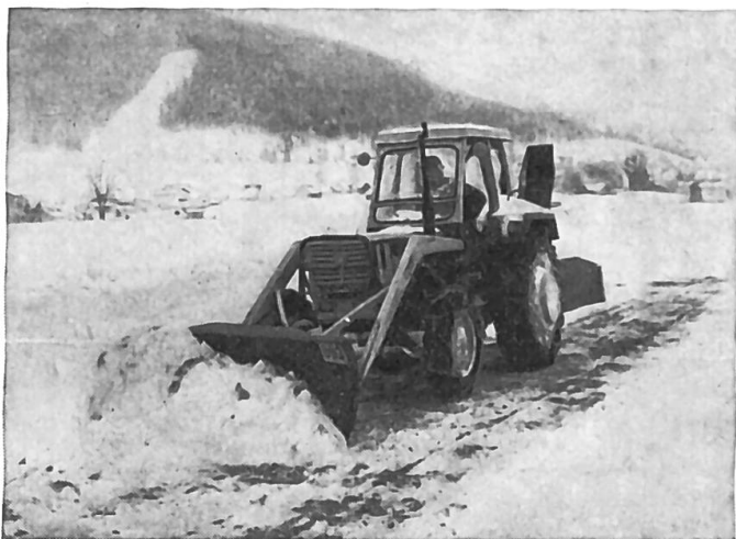
Fig. 2: Combinaison d'une fraiseuse à neige arrière et de la lame déblayeuse du chargeur frontal.
