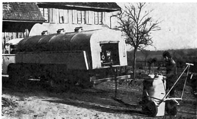
Fig. 1: Le lait n'est ramassé qu'une fois par jour ou tous les deux jours (camion-citerne). Pour faciliter le ramassage, le producteur de lait peut placer la citerne mobile de ferme sur un chariot spécial et l'amener jusqu'à la route.
