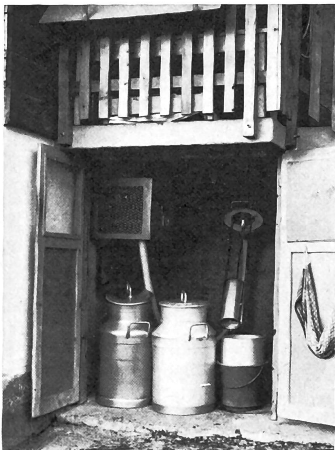
Fig.3: Réfrigération du lait en bidons avec le refroidisseur à immersion.
