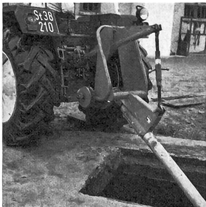
Fig. 1: Selon son type et son mode d'enclenchement, la prise de force peut être utilisée pour les travaux les plus divers, entre autres pour le broyage-brassage du lisier, comme ici. En ce qui concerne précisément ce travail, il est indiqué de l'effectuer avec différentes vitesses de rotation et selon les deux sens de rotation. Dans le cas de machines qui absorbent une grande puissance, il est toutefois nécessaire que le régime de la prise de force soit d'au moins 540 tr/mn (régime normalisé).
