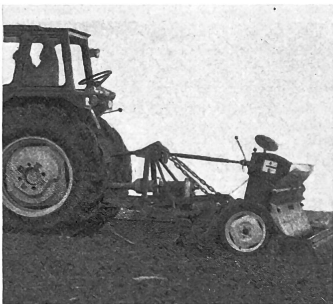
Fig. 3: Avec les machines de travail dont les besoins en puissance sont élevés, la prise de force rapide permet aussi de ménager la transmission dans une large mesure.
