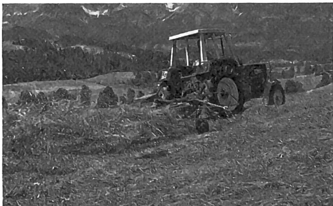
Fig. 2: La prise de force rapide (1000 tr/mn) donne la possibilité de rouler avec le tracteur en prise directe, par exemple avec les machines de fânage.
