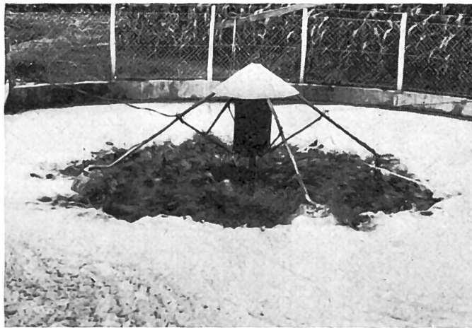
Fig. 2: Toupie, montée sur un système de flottaison, pour la ventilation du lisier en surface.
