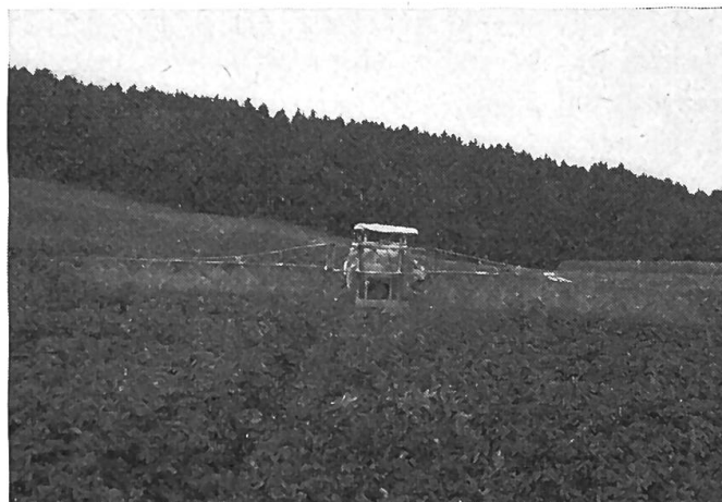
Fig. 2: Pulvérisateur utilisé dans un champ de pommes de terre. La largeur de travail et la vitesse de travail sont déterminées ici par les caractéristiques techniques de la machine et la quantité de produit phytosanitaire à épandre. Le conducteur du tracteur doit veiller à ce que le produit soit dosé avec précision, en faisant en sorte que la pression de service du pulvérisateur et la vitesse d'avancement ne varient pas. Une grande largeur de travail donne la possibilité de travailler rationnellement!
