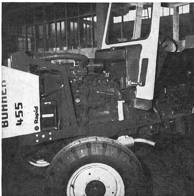
Fig. 1: Les espaces suffisants réservés ici autour du moteur représentent une solution exemplaire du point de vue de la facilité d'entretien et de réparation. Un tel accès aux divers organes peut en effet être considéré comme le meilleur possible.
