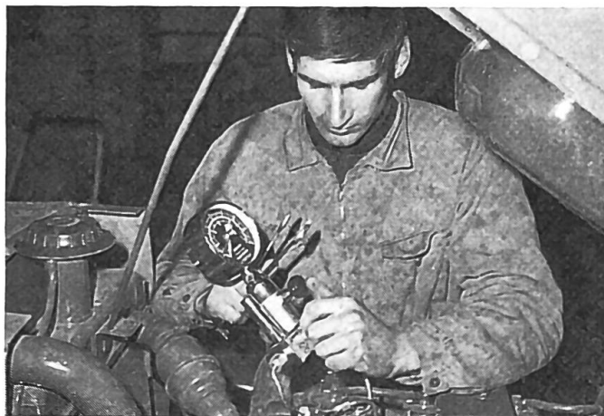
Fig. 2: Si le fabricant se voit vraiment obligé de placer par exemple le réservoir à carburant ou bien la batterie au-dessus du moteur, il devrait alors faire en sorte qu'on puisse facilement accéder aux injecteurs et aux soupapes en prévoyant que ce réservoir puisse basculer vers le haut ou que la batterie puisse pivoter sur le côté.
