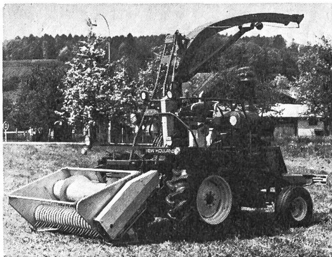
tambour ramasseur, équipement récolteur de maïs-fourrage pour 1 ou 2 rangs, mécanisme de fauchage, équipement récolteur d'épis de maïs.
