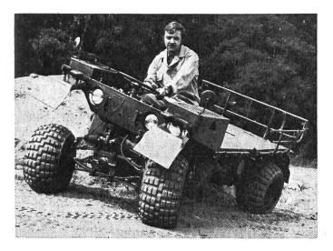
pneus permettent aussi au véhicule de passer des cours d'eau à gué lorsque cette dernière a jusqu'à 50 cm de profondeur.
