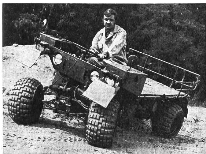
synchronisée formant bloc avec la transmission et le différentiel: 6 marches avant de 12 à 53 km/h et 1 marche arrière de 13 km/h, batterie de 12 volts, dynamo de 12 V/130 W, réservoir à carburant de 24,5 litres.
