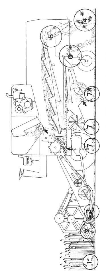
jusqu'à la corde. Les grains sont pulsés avec force hors de la machine par le tire-paille en passant par-dessus les secoueurs. Il faut contrôler les toiles d'arrêt de temps à autre et au besoin les remplacer!
