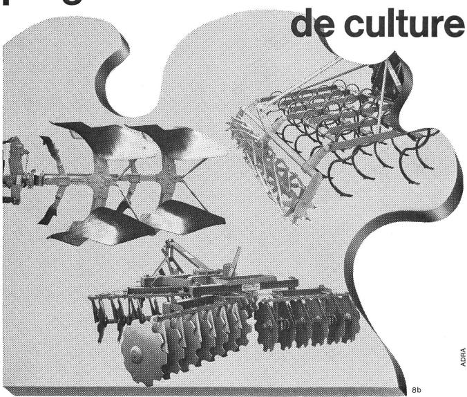
Charrues mono, bi- et trisocs · Chisels · Vibroculteurs · Cultivateurs à dents spirales · Herses à dents · Pulvériseurs à disques · Houes rotatives · Herses mobiles
