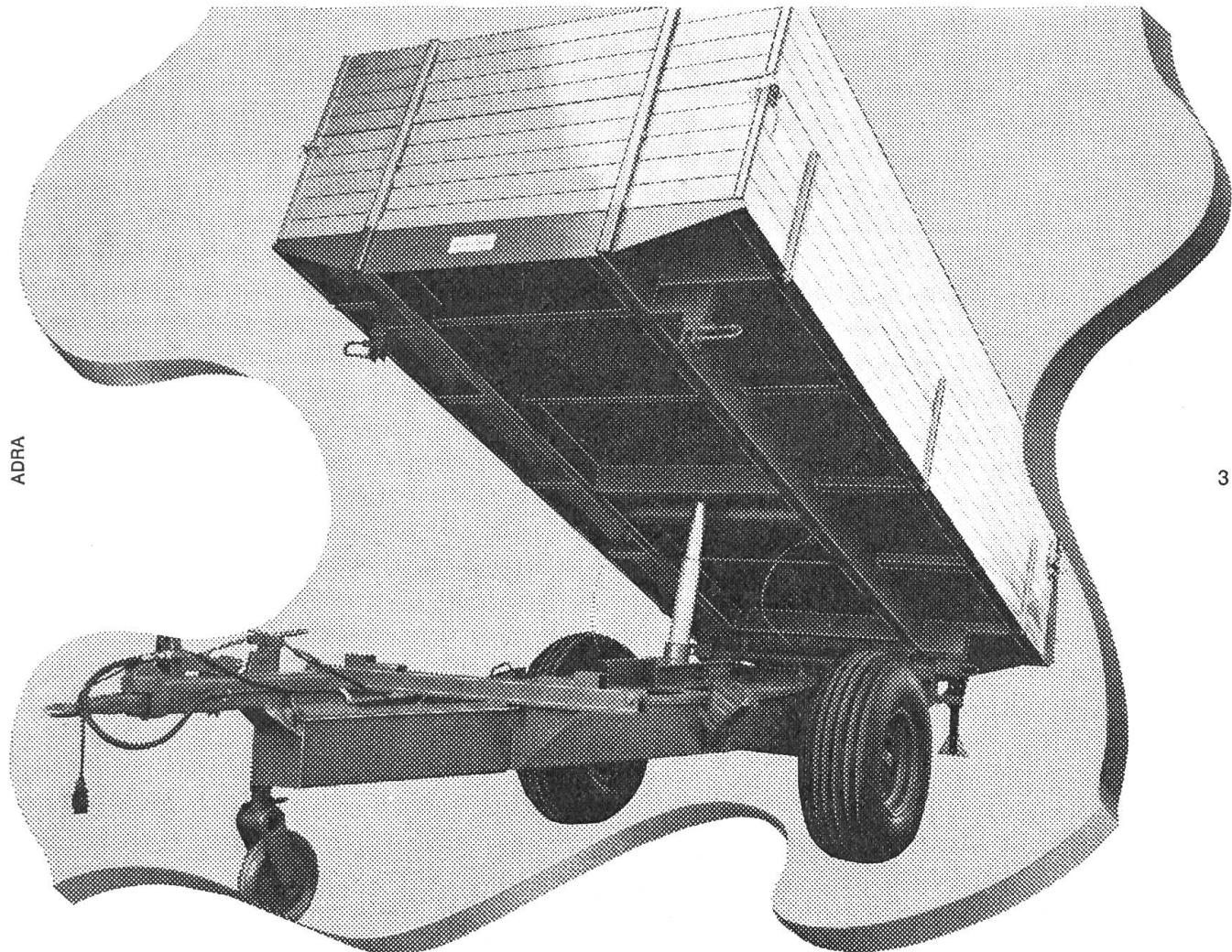
Remorques tout acier, basculantes 3 côtés — Contenance jusqu'à 8 m<sup>3</sup> — Dimensions du plateau jusqu'à 4.00 × 2.00 m — Châssis en V, en acier profilé — Paroi arrière articulée bas et haut, avec trappe réglable — Basculement par hydraulique tracteur ou pompe à prise de force ou à main — Frein à main et de poussée — Crochet d'attelage — Equipement électrique.
