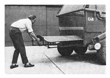
Fig. 1: Le séchage du grain (maïs compris) dans un conteneur de transport (séchoir statique) — Introduction du tablier de séchage en forme de toiture, avec sa plaque à perforations, dans le conteneur-séchoir. Ce tablier, facilement interchangeable, comprend un cadre tubulaire en acier et un treillis, aussi en acier, en plus de la plaque perforée.
