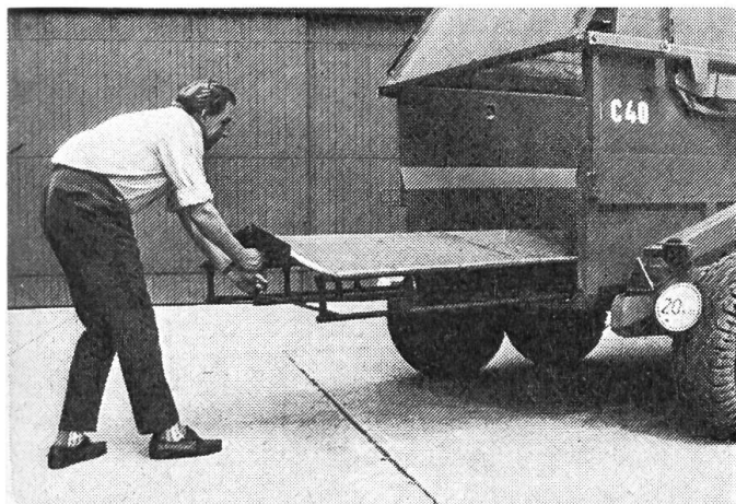
Fig. 1: Le séchage du grain (maïs compris) dans un conteneur de transport (séchoir statique) — Introduction du tablier de séchage en forme de toiture, avec sa plaque à perforations, dans le conteneur-séchoir. Ce tablier, facilement interchangeable, comprend un cadre tubulaire en acier et un treillis, aussi en acier, en plus de la plaque perforée.
