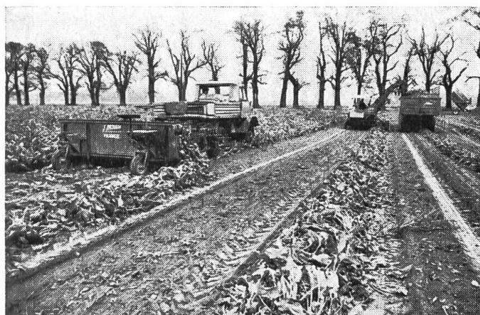
La méthode de récolte des betteraves sucrières en trois phases avec des machines simples à fort rendement à 6 rangs jouit d'une grande faveur en France mais n'est que peu répandue en Allemagne. Elle prévoit la mise en œuvre des matériels suivants: 1 décolleteuse, 1 arracheuse, 1 chargeuse, 2 remorques (à crochet d'attelage mobile à commande hydraulique) et 5 tracteurs.
