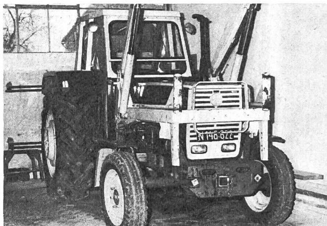
Fig. 6: Un alourdissement supplémentaire des roues arrière (motrices) par l'intermédiaire du relevage hydraulique à contrôle de profondeur lors de l'exécution de travaux de traction pénibles peut provoquer le cabrage de la machine en raison de l'allègement de l'essieu antérieur. C'est pourquoi il importe de monter des masses d'alourdissement à l'avant.
