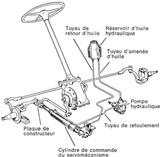
D'une manière générale, un servomécanisme hydraulique de direction s'avère particulièrement utile pour le tracteur durant la saison froide et en période de pointe. En outre, il entre également en considération pour d'autres machines automotrices telles que la moissonneuse-batteuse, etc.
