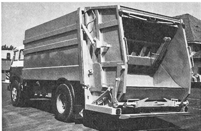
Fig. 4: Elle fournit également des superstructures prévues pour l'enlèvement des ordures ménagères (Swiss-Kéromat Apollo).
