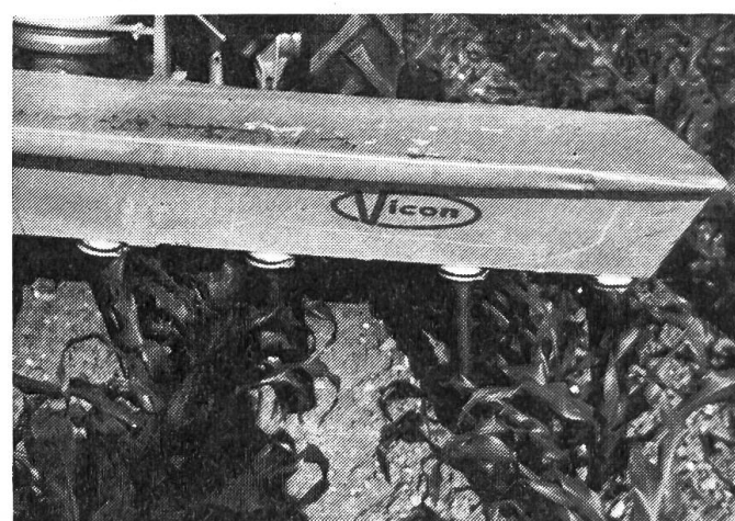
Fig. 4b: Vue partielle du dispositif de localisation de l'engrais en ligne et en surface Vicon. Au contraire des autres localisateurs, le fertilisant est épandu ici des deux côtés de chaque rangée de plantes.
