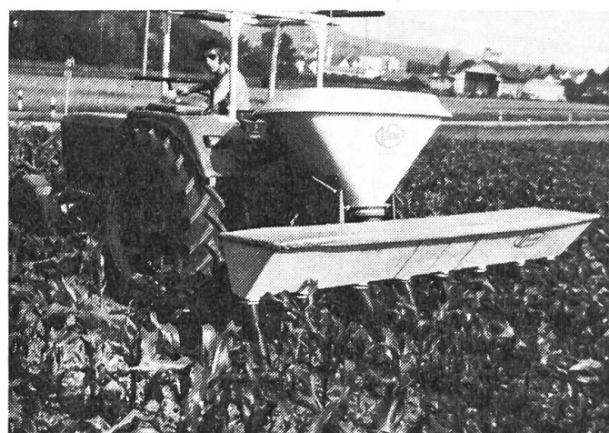
Fig. 4a: L'épandeur d'engrais Vicon à tube oscillant muni d'un dispositif de localisation du fertilisant en ligne et en surface à quatre rangs.
