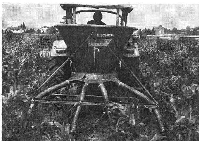
Fig. 3: L'épandeur d'engrais centrifuge Amazone à deux disques distributeurs pourvu d'un dispositif de localisation du fertilisant en ligne et en surface à quatre rangs. (Les tuyaux épandeurs flexibles sont fixés ici de manière provisoire).
