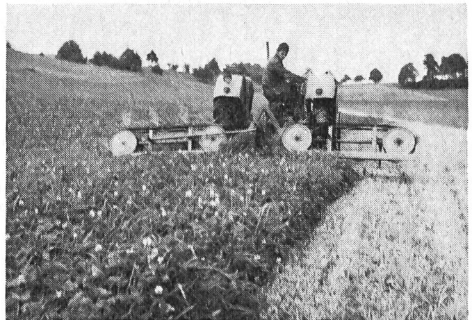
Fig. 2: Ce matériel combiné faucheur-andaineur comprend également deux barres de coupe qui permettent de récolter l'herbe sur une largeur d'environ 3 m 70 en un seul passage. Les deux andaineuses rejettent le fourrage vers l'intérieur pour former un andain régulier. Les barres de coupe s'adaptent bien aux inégalités du sol malgré leur grande largeur de travail totale. Le réalisateur de cette faucheuse-andaineuse à grande capacité de travail a prévu d'en faire ultérieurement un matériel frontal.
