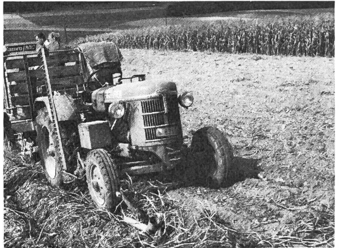
Fig. 2: Lorsque le tracteur et l'arracheuse-ramasseuse de pommes de terre roulent dans le sillon, ce dispositif est abaissé et il assure alors lui-même le guidage des machines de façon très précise, ce qui permet au conducteur d'aller aider les personnes de service se trouvant sur la récolteuse.
