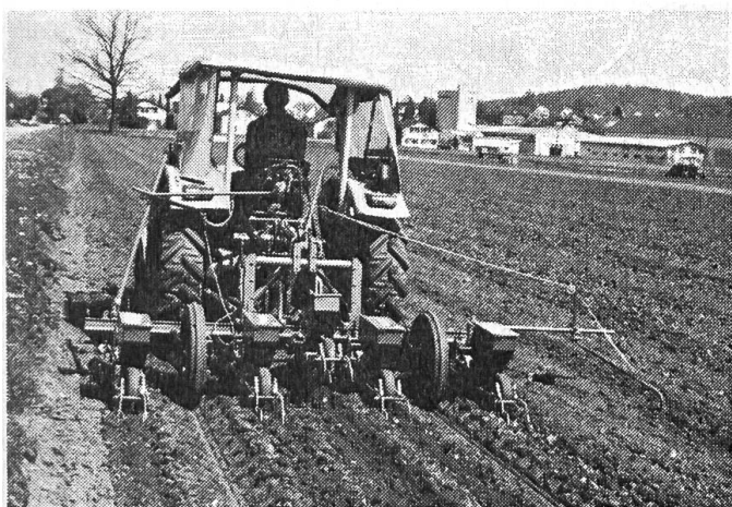
Fig. 8a: Machine Hassia-Exakta (machine de référence). Le semoir médian est relevé et son système d'entraînement déclenché.
