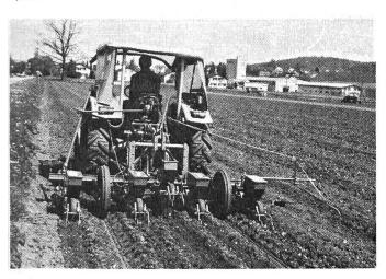
Fig. 8a: Machine Hassia-Exakta (machine de référence). Le semoir médian est relevé et son système d'entraînement déclenché.
