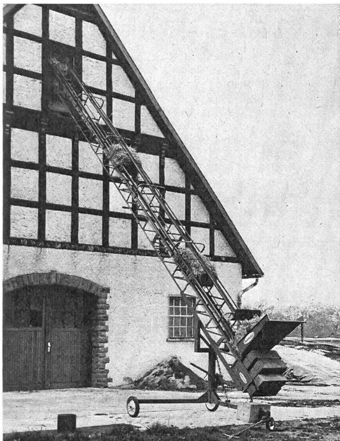
Le Diadème BL 4 peut être livré avec une longueur utile (convoyeur) de 7,8 ou 9 m. Sa capacité d'élévation maximale atteint 9 m. Le Diadème BL 5 peut être obtenu avec une longueur utile (convoyeur) de 10 ou 11 m. Il comporte un châssis renforcé qui est équipé d'un cric à crémaillère. Sa capacité d'élévation effective maximale représente 11 m, ce qui est vraiment exceptionnel.
