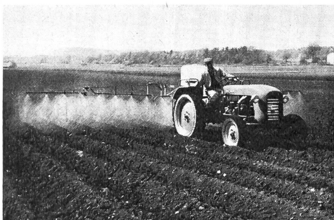
Fig. 1: Une répartition homogène de la bouillie phytosanitaire s'avère déterminante pour l'efficacité de la pulvérisation.
