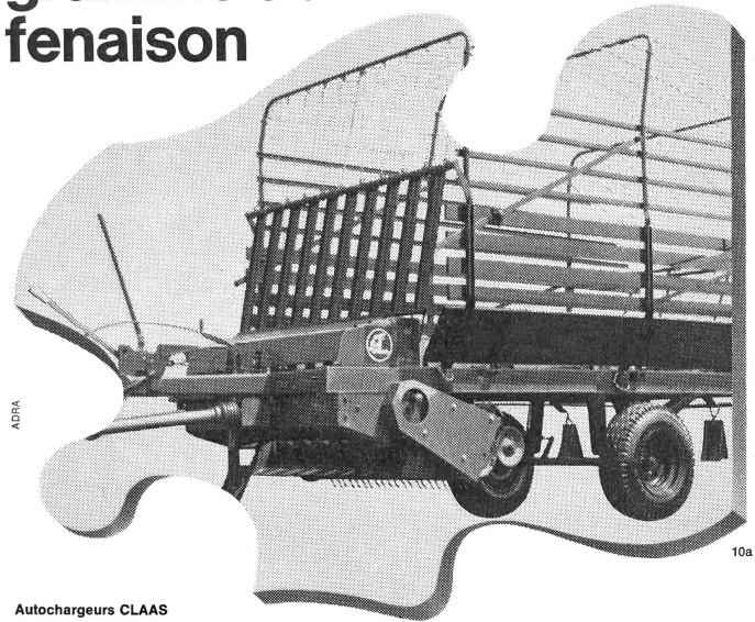
Large pick-up de 160 cm. — Adaptation parfaite au terrain. — Ramassage propre de tout fourrage, y compris feuilles de betteraves. — Ameneur oscillant ou à chaîne assurant un transport en douceur et efficace. — Dispositif de coupe jusqu'à 10 couteaux. — Superstructure facilement repliable. — Différents modèles d'une capacité de 10 — 25 m³. — Finition impeccable et équipement complet.
