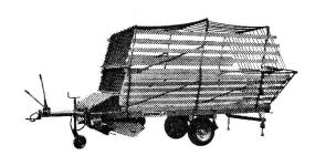
Autochargeuse Hagedorn, 6 modèles, contenance de 8 à 30 m³, exécution normale et surbaissée. Dispositifs de coupe avec 3, 7 ou 13 couteaux.
