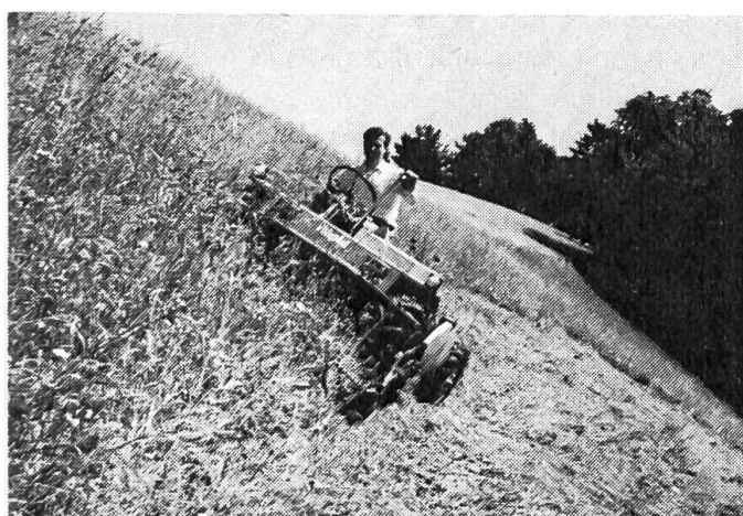
Fig. 1: La faucheuse automotrice polyvalente Heureka du modèle à quatre roues motrices exécutant la récolte du fourrage en roulant selon le sens des courbes de niveau.
