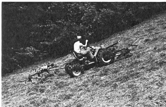
Fig. 3: La faucheuse automotrice polyvalente Heureka du modèle à quatre roues motrices effectuant l'épandage du fourrage avec la faneuse à toupies sur un champ d'un taux d'inclinaison de 35%.
