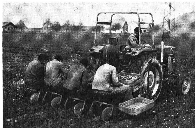
Fig. 6: Planteuse de pommes de terre pour 4 rangs à alimentation manuelle (machine de type traditionnel avec caissettes à claire-voie, gros tube de descente et signal sonore).
