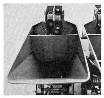
Fig. 11: Trémie à plants et ruban distributeur à deux rangs de godets de la planteuse de pommes de terre automatique Gruse.
