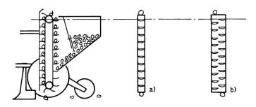
Fig. 2: Planteuse de pommes de terre automatique dont l'organe extracteur et distributeur est un:
