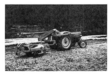
Caractéristiques techniques de l'écorceuse — Poids: environ 390 kg / Pneus 4,50 — 10 / Tracteur nécessaire: machine d'une puissance d'au moins 40 ch avec prise de force à régime de 1080 tr/mn / Vitesse d'écorçage: de 28 à 42 mm/mn / Possibilités d'écorçage: troncs d'un diamètre de 15 à 50 cm / Ecorçage de troncs d'environ 30 cm de diamètre représentant le traitement d'environ 18 m³ à l'heure / Ecorçage de troncs d'environ 20 cm de diamètre égal au traitement d'environ 11 m³ à l'heure.
