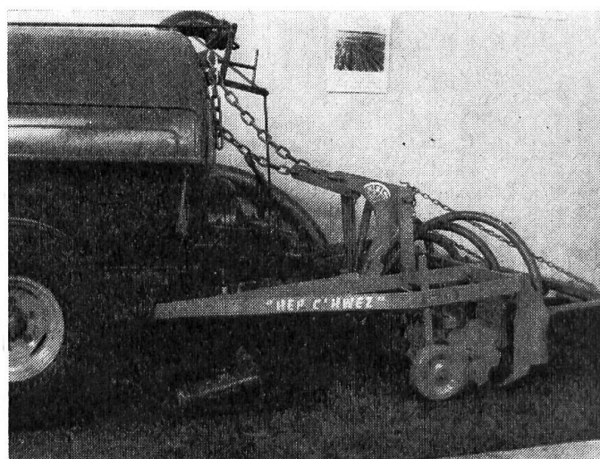
Fig. 12: Epandeur de lisier à pompe à liquides équipé d'un système de distribution permettant d'injecter le lisier directement dans le sol, à quelques centimètres de profondeur, sans aucune perte. Le sol absorbe immédiatement cet engrais liquide. A relever en outre que toute mauvaise odeur se trouve ainsi supprimée, ce qui s'avère très précieux du point de vue de l'environnement.
