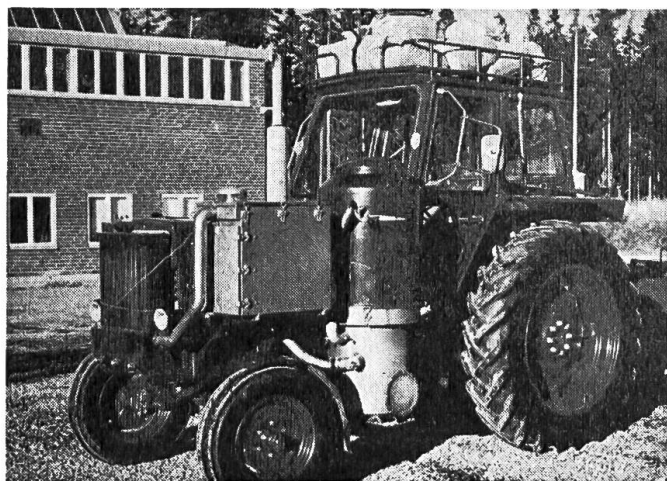
Fig. 1: Tracteur de type moderne à moteur Diesel équipé d'un générateur de gaz de bois (gazogène).
