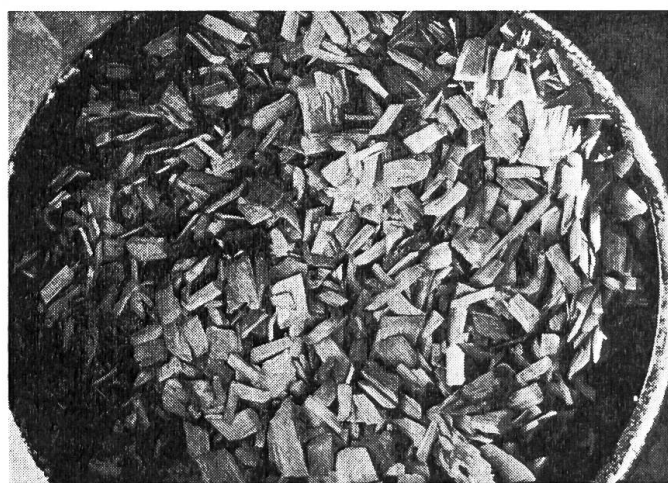
Fig. 7: Des essais sont actuellement effectués en Suède en utilisant du bois sous forme de petites lamelles dans les gazogènes.
