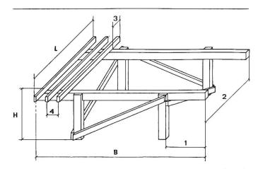
Fig. 3: Dessin schématique montrant le mode de construction d'un élément de plancher à claire-voie.
