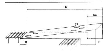
Fig. 2: Gaine d'amenée d'air et raccordement des éléments du plancher à claire-voie à ce canal.
