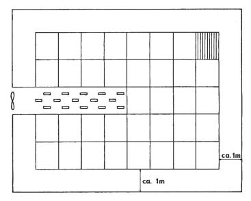
Fig. 1: Vue en projection horizontale d'une installation pour le postséchage du foin mi-sec sous toit avec aérateur de grange, plancher à claire-voie à éléments multiples et gaine d'amenée d'air.
