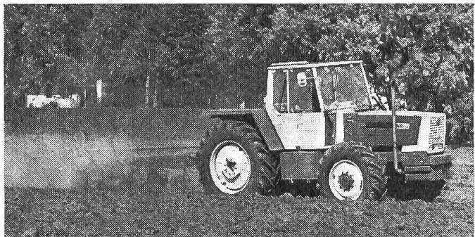
ses masses d'alourdissement soit réparti dans une proportion de 45% sur les roues motrices arrière et de 55% sur les roues motrices avant, ce qui donne un rapport optimal des charges de 40 : 60. Ce rapport représente en revanche 50 : 50 si le tracteur n'a pas été pourvu de ses masses d'alourdissement. Une telle répartition du poids total, combinée avec l'empattement favorable de la machine, confère à ce tracteur également de très remarquables aptitudes routières.
