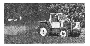
ses masses d'alourdissement soit réparti dans une proportion de 45% sur les roues motrices arrière et de 55% sur les roues motrices avant, ce qui donne un rapport optimal des charges de 40:60. Ce rapport représente en revanche 50:50 si le tracteur n'a pas été pourvu de ses masses d'alourdissement. Une telle répartition du poids total, combinée avec l'empattement favorable de la machine, confère à ce tracteur également de très remarquables aptitudes routières.
