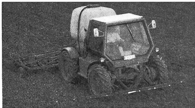
Fig. 9: Aspect du nouveau tracteur porteur «Deutz-Intrac» à deux ou quatre roues motrices. Il permet de réduire le nombre des passages nécessaires par l'emploi simultané de matériels de travail à l'avant et à l'arrière.
