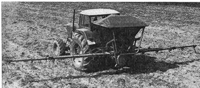
Fig. 4: Le distributeur d'engrais pneumatique «Nodet» peut être équipé d'un cylindre doseur à ergots très fins qui donne la possibilité d'employer cette machine également pour l'épandage des microgranulés.
