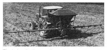
Fig. 4: Le distributeur d'engrais pneumatique «Nodet» peut être équipé d'un cylindre doseur à ergots très fins qui donne la possibilité d'employer cette machine également pour l'épandage des microgranulés.
