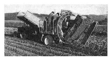
Fig. 8: Dans le secteur des machines exécutant la récolte totale des pommes de terre, on a pu constater que la majorité de ces matériels étaient pourvus d'une trémie à paroi roulante. Cette solution assure un chargement continu durant l'arrachage et endommage moins les tubercules.
