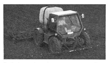
Fig. 9: Aspect du nouveau tracteur porteur «Deutz-Intrac» à deux ou quatre roues motrices. Il permet de réduire le nombre des passages nécessaires par l'emploi simultané de matériels de travail à l'avant et à l'arrière.
