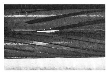
Aspect des rouleaux d'un conditionneur réalisant l'écrasement du fourrage.
